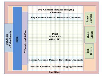
Fig. 3. ROIC Floor plan
